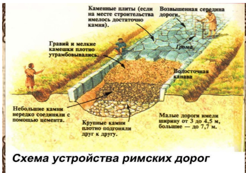
Рисунок 3 – Технологическая схема устройства римских дорог
